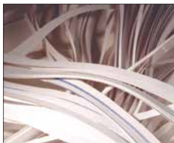
Tira continua (orillos) generados en el desbarbe de bobinas
